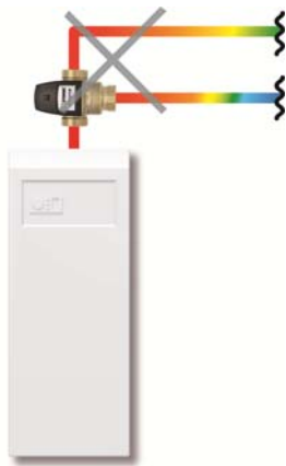
Fig. 4. Exempel på icke korrekt installation av termostatisk blandningsventil.
